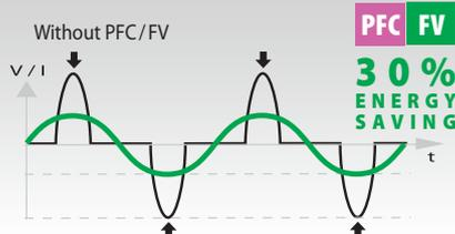
TIG 200 DC оснащен PFC (ККМ) большого диапазона, позволяющий иметь FLEXIBLE VOLTAGE (85-265В).
