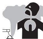
I fumi, gas e polveri emesse dalla saldatura sono pericolosi per la salute. È necessario prevedere una ventilazione sufficiente e a volte è necessario un apporto d'aria. Una maschera ad aria fresca potrebbe essere una soluzione in caso di aerazione insufficiente.
