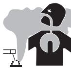
El humo, el gas y el polvo que se emite durante la soldadura son peligrosos para la salud. Hay que prever una ventilación suficiente y en ocasiones puede ser necesario un aporte de aire. Una máscara de aire puede ser una solución en caso de aireación insuficiente.
