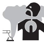
Dampen, gassen en stof uitgestoten tijdens het lassen zijn gevaarlijk voor de gezondheid. Zorg voor voldoende ventilatie, soms is toevoer van verse lucht tijdens het lassen noodzakelijk. Een lashelm met verse luchtaanvoer kan een oplossing zijn als er onvoldoende ventilatie is. Controleer of de zuigkracht voldoende is, en verifieer of deze aan de gerelateerde veiligheidsnormen voldoet.
