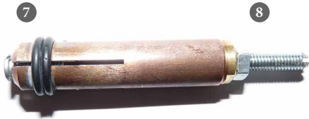
4-schlitzige Kupferbolzenaufnahme für M4 Schweißbolzen (Ø 4 mm)
