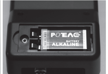
Colocar una nueva pila 9 V en el compartimiento
