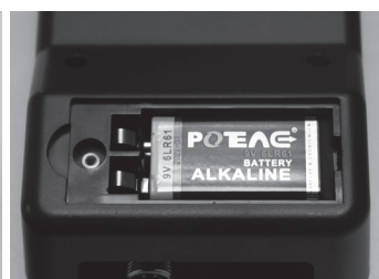
Replacer une nouvelle pile 9V dans le compartiment
