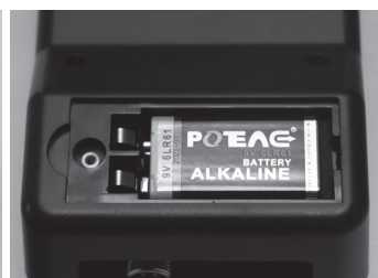
Riposizionare nel vano una nuova pila 9V
