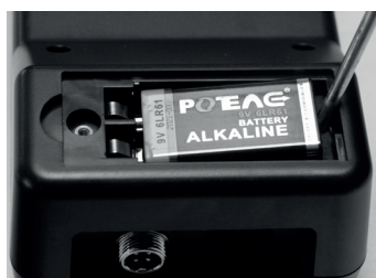
Retirer la pile en faisant levier avec un tournevis
