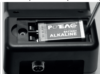
Извлеките аккумулятор, поддев его отверткой.
