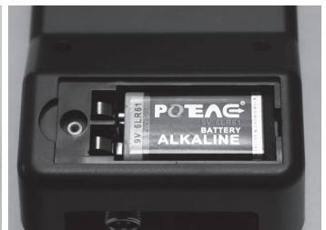
Plaats een nieuwe 9V batterij in het compartiment
