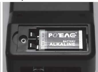
Замените новый аккумулятор Батарея 9 В в отсеке
