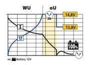
• Заряжает на 100% свинцовые АКБ с жидкостным или гелиевым электролитом (Кривая WuoU) емкостью от 20 до 180Ач.
