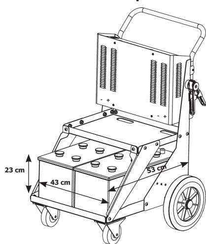
Avant toute utilisation, installer les deux batteries « internes » (non fournies): batteries au plomb à électrolyte liquide ou gel 12V d'une capacité de 120 à 180 Ah maximum chacune. Leurs dimensions ne doivent pas excéder 45 x 53 x 23 cm et le poids total max 100 kg.
