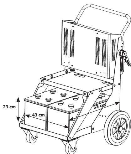
Verbinden Sie, bevor Sie das Gerät anwenden, die beiden internen Batterien (nicht im Lieferumfang enthalten) wie folgt an:
