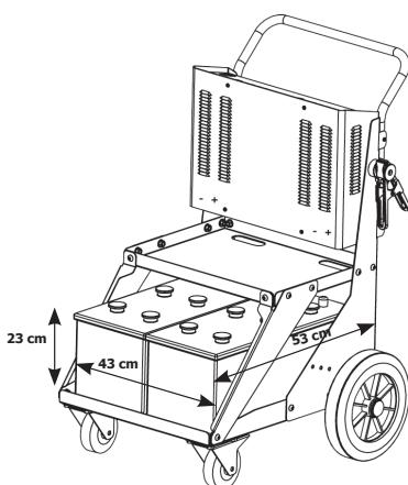
Перед использованием установите 2 «внутренних» аккумулятора (не поставляемые с аппаратом): свинцовые 12-вольтовые аккумуляторы с жидким или гелевым электролитом ёмкостью от 120 до 180 А/часов максимум каждый. Их размеры не должны превышать 45x53x23 см и максимальный вес 100 кг.
