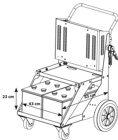
Antes del uso, instalar las dos baterías « internas » (no incluidas): baterias al plomo a electrolito líquido o gel de 12V con capacidad de 120 a 180 Ah como máximo cada una. Sus dimensiones no deben superar 45x 53x23 cm con un peso total máximo de 100 kg.
