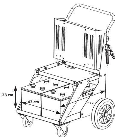
Installeer, voor ieder gebruik, de twee «interne» accu's (niet meegeleverd): 12V elektrolyt loodaccu's, liquide of gel met een maximale capaciteit van 120 tot 180 Ah elk. De afmetingen van deze accu's mogen niet groter zijn dan 45x 53x23 cm. Ze mogen niet zwaarder zijn dan 100 kg.
