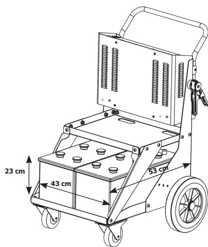
Prima di qualsiasi utilizzo, installare le due batterie « interne » (non fornite): batterie al piombo ad elettrolito liquido o gel 12V con capacità da 120 a 180 Ah massimo ciascuna. Le loro dimensioni non devono superare 45 x 53 x 23 cm e il peso totale max 100 kg.
