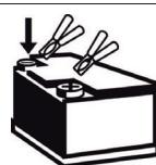
**! ERROR** En caso de inversión de polaridad, el STARTPACK PRO 12.24 XL le indica: Buzzer + led rojo encendido.
