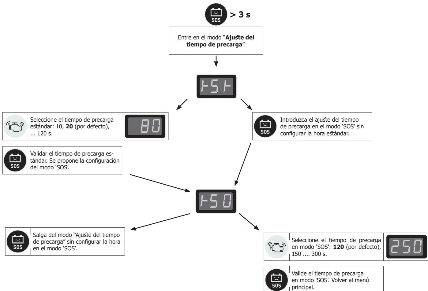
**En el modo SOS, no hay más protecciones (en la tensión de 12 V / 24 V, en caso de inversión de polaridad...).**
