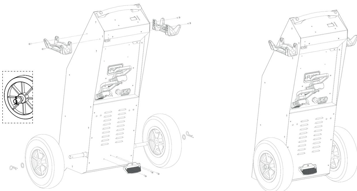
**2** Устройство Gysflash 6.12 XL и сетевой шнур могут крепиться на устройство STARTPACK PRO 12.24 XL или храниться отдельно (винты входят в комплект).
