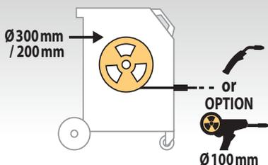
**Адаптируемый:** аппарат M1 GYS AUTO может комплектоваться горелкой Spool Gun. Эта приводная горелка имеет кассету для катушек  $\varnothing 100$  мм алюминиевой, медной, стальной проволоки и проволоки из нержавеющейки  $\varnothing 0,8$  мм.
