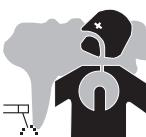
Beim Schweißen entstehen Rauchgase bzw. giftige Dämpfe, die zu Sauerstoffmangel in der Atemluft führen können. Sorgen Sie daher immer für ausreichend Frischluft, technische Belüftung (oder ein zugelassenes Atmungsgerät).
