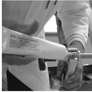
❷ Нанесите смазку внутри зажима и на стержень инструмента
