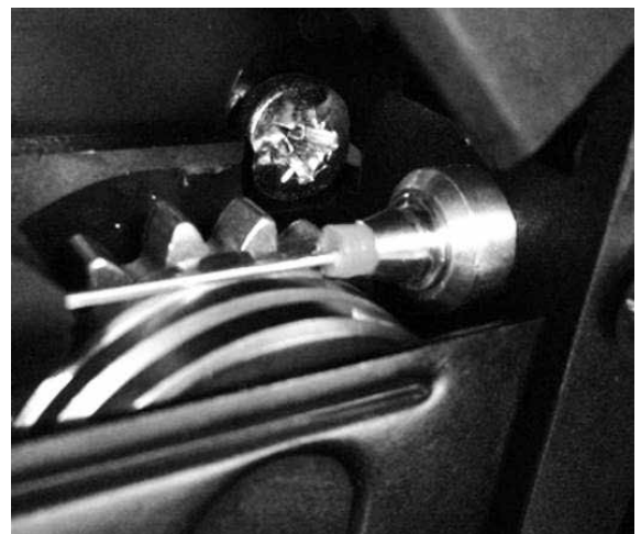
Tijdens het gebruik van een rode of blauwe mantel (aluminium lassen) wordt aanbevolen accessoire 91151 te gebruiken (Zie foto). Deze inox geleidingshuls zorgt voor een betere centrering van de mantel en vergemakkelijkt de aanvoer van de draad.
