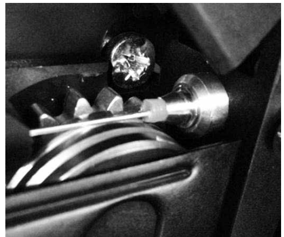
При использовании красной или синей трубки (при сварке алюминия) рекомендуется пользоваться аксессуаром 91151 (см. фотографию). Этот аксессуар из нержавеющей стали направляет трубку, улучшая ее центрирование и облегчая подачу проволоки.
