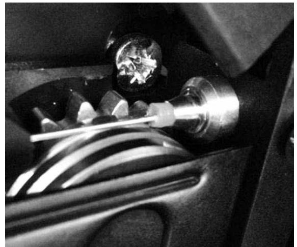
Lors de l'utilisation de gaine rouge ou bleu (soudage aluminium), il est conseillé d'utiliser l'accessoire 91151. Ce guide gaine inox améliore le centrage de la gaine et facilite le débit du fil.
