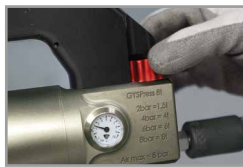
Настройка давления от 0 > 8 бар
