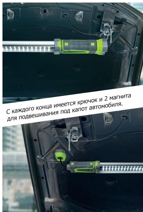
С каждого конца имеется крючок и 2 магнита для подвешивания под капот автомобиля.
