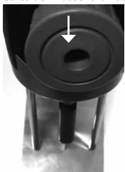
Verriegelungsrad für die Stifte der Masseverbindung:
