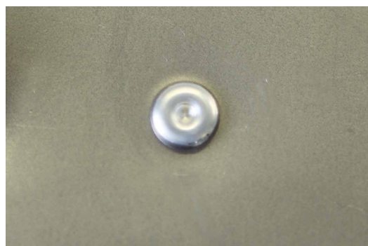
RISULTATO DELLA POSA DI UN RIVETTO FLOW-FORM
