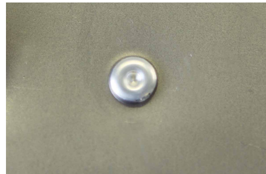
ERGEBNIS DER APPLIKATION EINES FLIESSFORMNIETES
