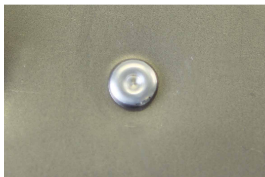
RÉSULTAT DE POSE D'UN RIVET FLOW-FORM
