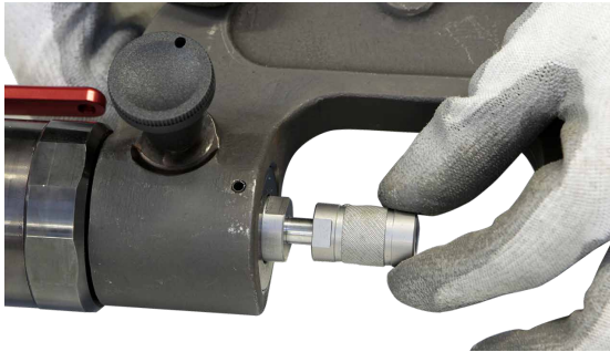
Schrauben Sie den Verlängerungsadapter an den Arm.
