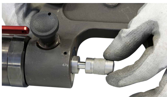
Привинтите насадку, идущую в комплекте с плечом.
