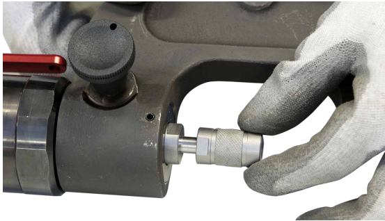
アーム備品のエクステンションをネジ付けしてください。
