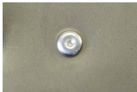
РЕЗУЛЬТАТ УСТАНОВКИ ЗАКЛЕПКИ ТЕКУЩЕЙ ФОРМЫ FLOW-FORM
