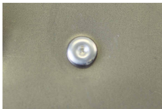
RESULTADO AL PONER UN REMACHE FLOW-FORM
