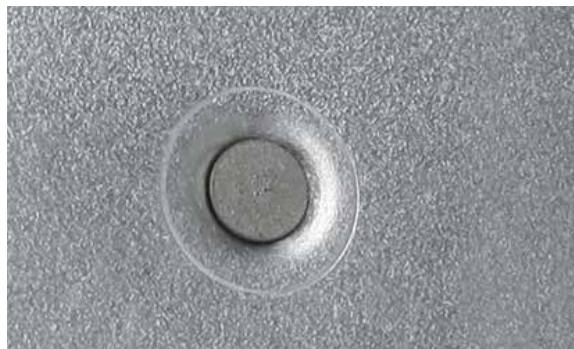
RISULTATO DELLA POSA DI UN RIVETTO AUTO-PERFORANTE
