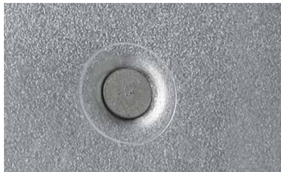
AFBEELDING PONSNAGEL VERBINDING VOOR- EN ACHTER-ZIJDE
