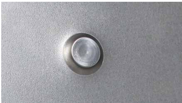
RESULTADO AL PONER UN REMACHE AUTOPERFORANTE
