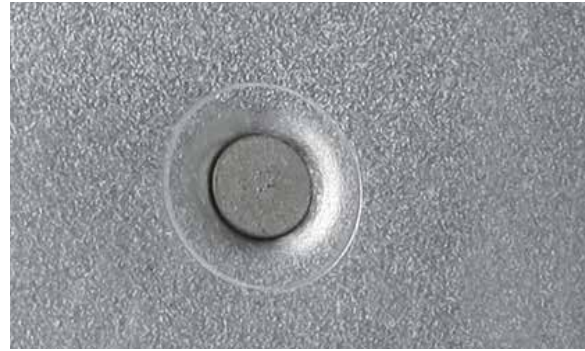
ABBILDUNG STANZNIETVERBINDUNG VORDER- U. RÜCKSEITE
