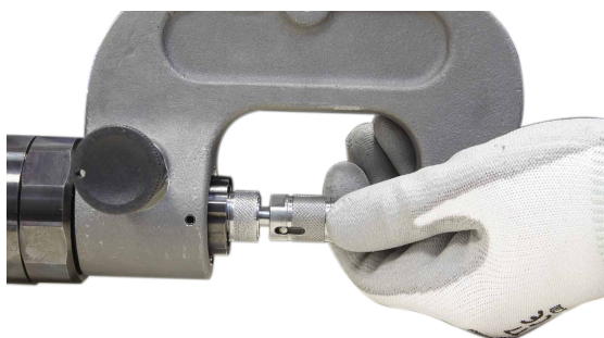
Привинтите насадку, идущую в комплекте с плечом.
