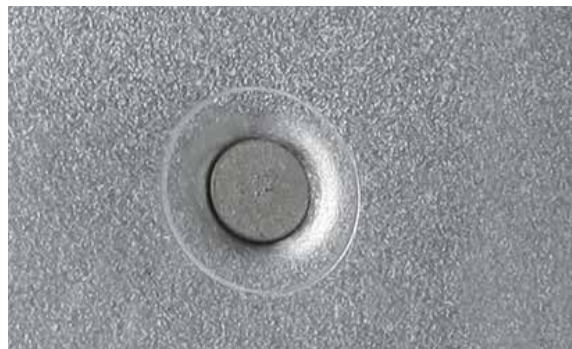
РЕЗУЛЬТАТ УСТАНОВКИ САМОПРОНИКАЮЩЕЙ ЗАКЛЕПКИ
