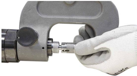
Schrauben Sie den Verlängerungsadapter an den Arm.
