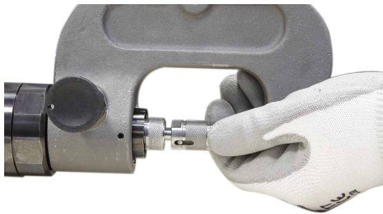
Atornillar la prolongación incluida con el brazo.
