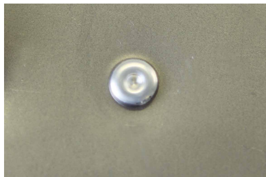
RISULTATO DELLA POSA DI UN RIVETTO FLOW-FORM
