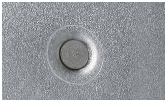
RISULTATO DELLA POSA DI UN RIVETTO AUTO-PERFORANTE
