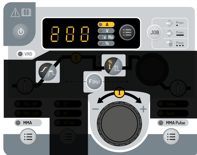
MMA PULSE (Lichtbogenhandschweißen, gepulst) Schattierte Bereiche sind in diesem Modus nicht hilfreich.
